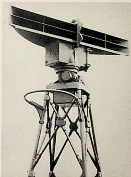
Antenne und Hf-Einheit der Kurs-Radaranlage TM 46
