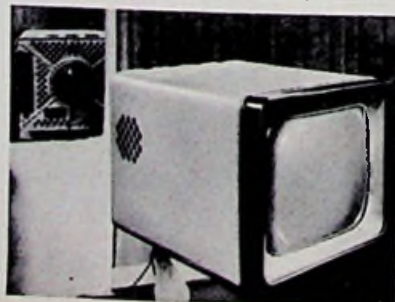
Bild 1. Pastellfarbiger russischer Fernseh-Kleinempfänger (Portable) mit 36-cm-Bildröhre. Die Bedienungsköpfe sind auf der rechten Seite bzw. rückseitig
